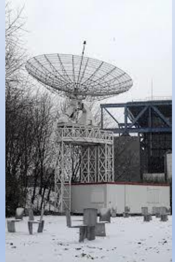
Radiotélescope La Villette ; diamètre 10 m ; gain 40 dB à 1296-1400 MHz
